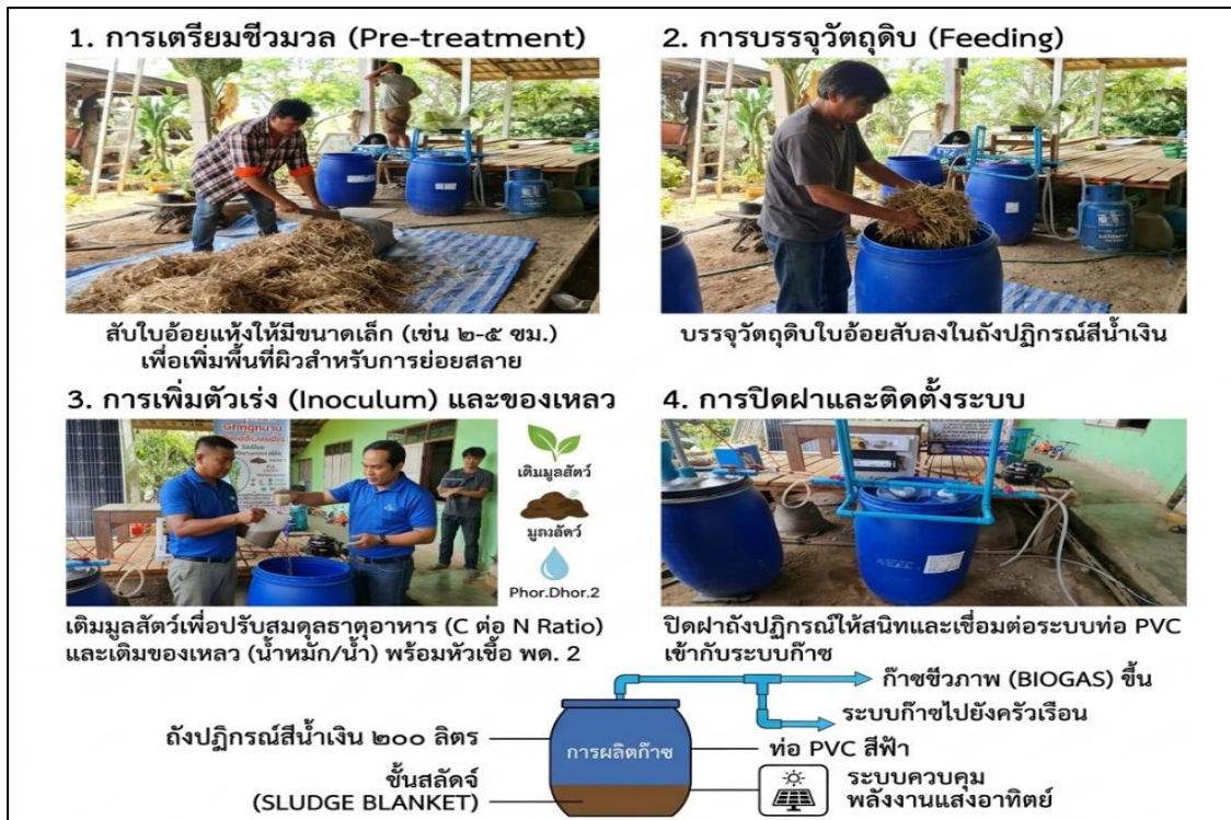
รูปที่ 3.5 ขั้นตอนการเตรียมชีวมวลและการบรรจุวัตถุดิบ
